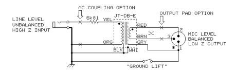
\* THE HOUSING OF THE OUTPUT CONNECTOR SHOULD BE INSULATED FROM THE CHASSIS.
